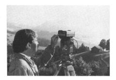
Auf Tastendruck misst dieser Distomat Wild DI3000 in nur 0,8 Sekunden Distanzen bis zu 14 km mit geodätischer Genauigkeit. Aufsetzbar auf optische Theodolite (im Bild auf Wild T2), elektronische Wild-Theodolite oder als Soloinstrument in Wippe.
