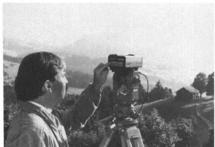
Auf Tastendruck misst dieser Distomat Wild DI3000 in nur 0,8 Sekunden Distanzen bis zu 14 km mit geodätischer Genauigkeit. Aufsetzbar auf optische Theodolite (im Bild auf Wild T2), elektronische Wild-Theodolite oder als Soloinstrument in Wippe.
