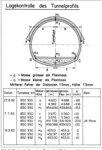
Abb. 3: Baukontrollen eines Tunnelprofils in verschiedenen Bauphasen.
