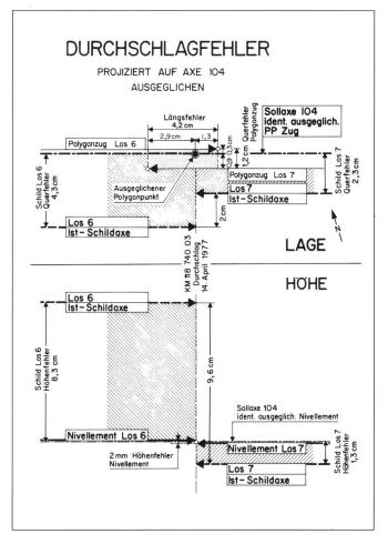
Abb. 4b: Darstellung des Durchschlagfehlers und Lage der Schilde nach dem Ausgleich.
