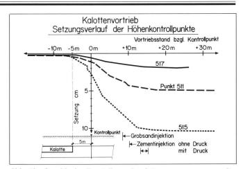
Abb. 5b: Graphische Darstellung der Setzungsmessungen mit den dazugehörigen Bauzuständen.
