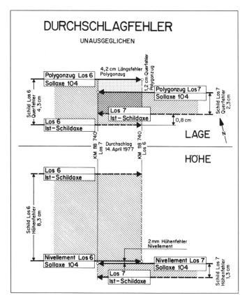
Abb. 4a: Baukontrolle eines Tunnels beim Durchschlag (unausgeglichenes System).
