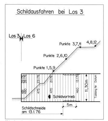
Abb. 6a: Verschiebungsmessungen beim Schildausfahren.
