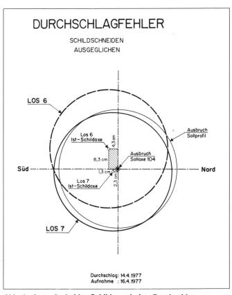
Abb. 4c: Lage der beiden Schilde nach dem Durchschlag im ausgeglichenen System.
