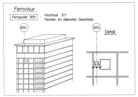
Abb. 2: Skizze für Einstellung des Fadenkreuzes einer Fernvisur.
