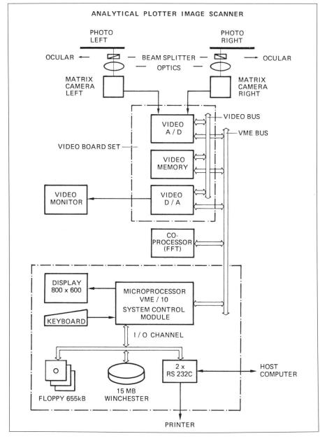
Abb. 4: Zweibild-Digitalisiersystem (verwendbar zur Installation an einem Analytischen Plotter, Wild, Heerbrugg)
