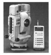
Die Totalstation Et-1 ist das Flaggschiff einer kompletten Gerätefamilie für die computer-unterstützte und millimetergenaue Vermessung. Reichweiten von bis zu 2600 m, elektronische Winkelmessung, berührungsfreie Bedienung, automatische Kompensation der Erdkrümmung und externe Datenspeicher sind nur einige der vielen Rosinen.
