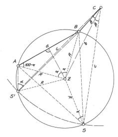
$\alpha$  ist ein Peripheriewinkel über der Sehne A-B im Kreis mit dem Radius R und dem Zentrum Z. S und S' sind die Schnittpunkte der Kreise mit den Zentren Z und C sowie den zugehörigen Radien R und c. Somit hat die Aufgabe 2 Lösungen.
