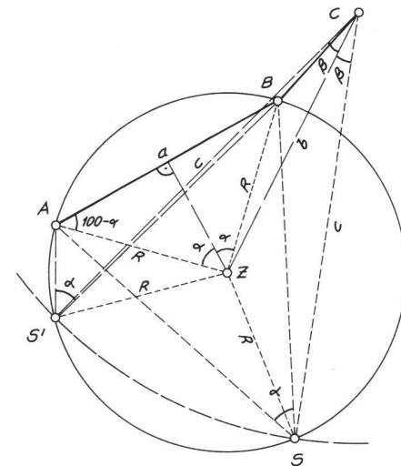
$\alpha$  ist ein Peripheriewinkel über der Sehne A-B im Kreis mit dem Radius R und dem Zentrum Z. S und S' sind die Schnittpunkte der Kreise mit den Zentren Z und C sowie den zugehörigen Radien R und c.
