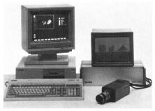
Abb. 2 zeigt das Videobildverarbeitungssystem Viper, welche drei Einsatzschwerpunkte hat: Bildausweitung, Bildbearbeitung und Mustererkennung.
