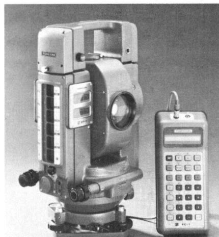
Abb. 1 zeigt die Totalstation ET-1 von Topcon. Sie ist das Flaggschiff einer kompletten Gerätelinie für die computerunterstützte und millimetergenaue Vermessung. Reichweiten von bis zu 2600 m, elektronische Winkelmessung, berührungslose Bedienung, automatische Kompensation der Erdkrümmung und externe Datenspeicher sind nur einige der vielen Vorteile.
