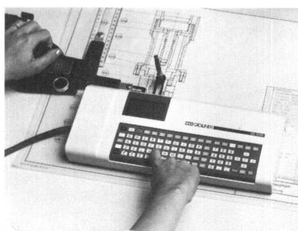
Der Permanentspeicher hat eine Kapazität von 8000 Zeichen. Verschiedene Schriftarten und Symbol-Module (Architektur, Elektrotechnik, Elektronik) sind verfügbar sowie auch Eigenprogrammier- und Menü-Module. Verblüffend viel Software und Ausbaubarkeit bis zum Anschluss an Ihre externen Datenträger, z.B. PC, zur Übermittlung und Weiterverarbeitung der Daten.
