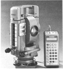
Abb. 1 zeigt die Totalstation ET-1 von Topcon. Sie ist das Flaggschiff einer kompletten Gerätefamilie für die computerunterstützte und millimetergenaue Vermessung. Reichweiten von bis zu 2600 m, elektronische Winkelmessung, berührungsfreie Bedienung, automatische Kompensation der Erdkrümmung und externe Datenspeicher sind nur einige der vielen Vorteile.
