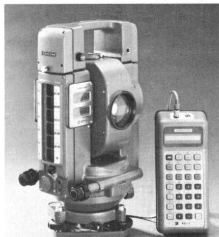
Abb. 1 zeigt die Totalstation ET-1 von Topcon. Sie ist das Flaggschiff einer kompletten Gerätefamilie für die computerunterstützte und millimetergenaue Vermessung. Reichweiten von bis zu 2600 m, elektronische Winkelmessung, berührungslose Bedienung, automatische Kompensation der Erdkrümmung und externe Datenspeicher sind nur einige der vielen Vorteile.
