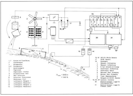
Abb. 1: Schematische Darstellung der Messanlage.
