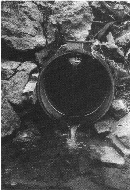
Abb. 2: Auslauf des Strassendurchlass-Rohres (8). Im Rohrrinnern ist der Schwenkarm des Mess-Schwimmers (9) zu erkennen.
