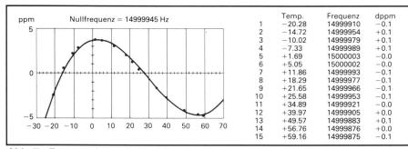
Abb. 7: Frequenzkurve in Funktion der Temperatur.
