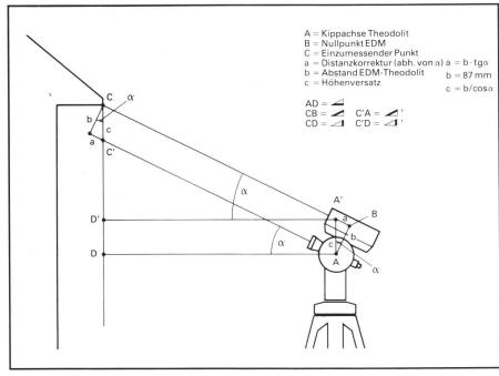
Abb. 12: Distanzkorrektur bei geneigten Visuren.
