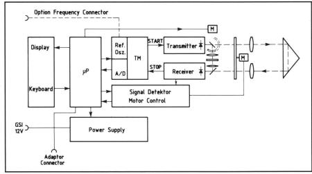
Abb. 4: Blockdiagramm der Elektronik.
