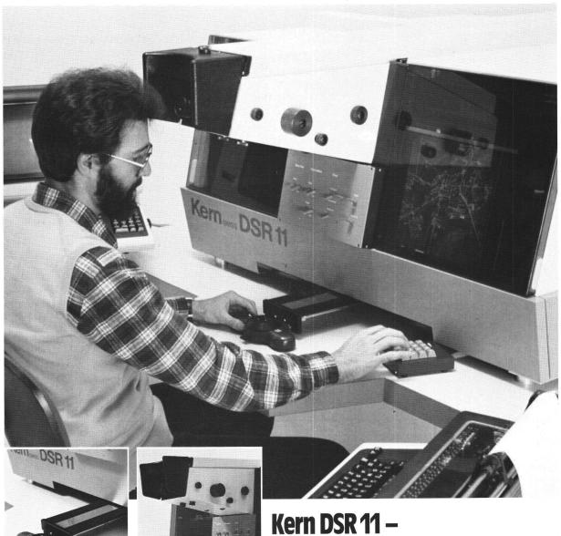
Bequeme Freihandführung für X-, Y- und Z-Bewegungen. Wahlweise werden auch X-, Y-Handräder, Z-Fussscheibe oder X-, Y-Trackball geliefert. Bildpaare aufgenommen aus unterschiedlichen Flughöhen und mit unterschiedlichen Brennweiten: Problemlose Auswertung dank der Kern Software und der für links und rechts einzeln oder gemeinsam regulierbaren Standard-Zoomoptik.
