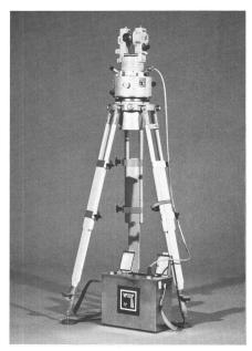
Abb. 1: Vermessungskreisel GYROMAT
