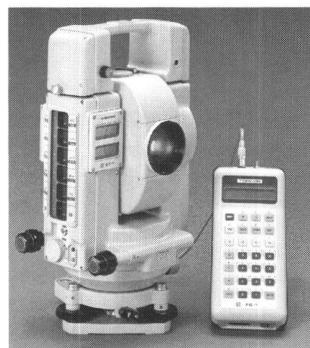
Die Totalstation Et-1 ist das Flaggschiff einer kompletten Gerätefamilie für die computerunterstützte und millimetergenaue Vermessung. Reichweiten von bis zu 2600 m, elektronische Winkelmessung, berührungsreie Bedienung, automatische Kompensation der Erdkrümmung und externe Datenspeicher sind nur einige der vielen Rosinen.
