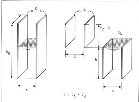
Fig. 4: Mesure d'un niveau d'eau par enregistrement des variations de la capacité entre deux armatures plongées dans le liquide.
