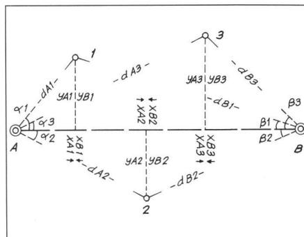
Berechne die Winkel  $d$  und  $S$  und dann mit diesen sowie den zugehörigen Distanzen ( $d$ ) alle Abszisse (X) und Ordinaten (Y) von A und B aus. Wenn alle Messungen fehlerfrei sind, dann müssen je  $YA$  und  $YB$  gleich gross sein. Die Summe der Werte  $XA$  und  $XB$  muss der PP Seitenlänge entsprechen (Toleranz beachten).
