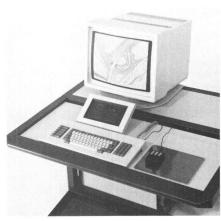
SYSTEM 9-E: Edierstation des SYSTEMS 9 mit grossem farbigem Raster-Graphikbild-schirm, Tastatur, Maus und Digitalisiertablett sowie dem kleineren graphischen CIS-Bildschirm für die Eingabe von Befehlen durch leichte Berührung. Der leistungstarke Mikrocomputer mit der relationalen Datenbank ist innerhalb der Station unter dem Graphikbildschirm plaziert.
