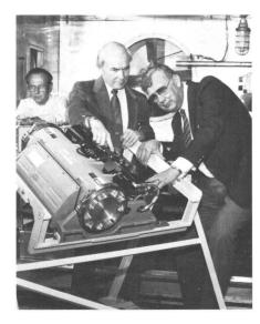
Radar Bilder zur Kartenherstellung aus grossen Distanzen sind photographischen und optischen Methoden überlegen, da die Atmosphäre mehr Strahlung im sichtbaren und Infrarot-Bereich des Spektrums absorbiert als in den Frequenzbereichen des Radars. Die Radar System Gruppe entwickelte dieses System im Auftrag der «US Air Force Aeronautical Systems Division», Wright-Patterson Air Force Base, Ohio.
