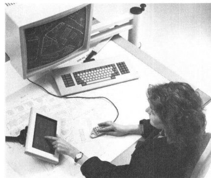
SYSTEM 9-D: Digitalisierstation des SYSTEMS 9 zur Eingabe von Daten ab vorhandenen Plänen und Karten in das geographische Informationssystem.
