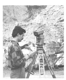
Mit einer Kombination aus DIOR 3002, elektronischem Theodolit Wild T 1000, Datenterminal Wild GRE 3 und DIOR - Software können reflektorlos viele Vermessungsaufgaben an nicht zugänglichen Objekten durchgeführt werden.
