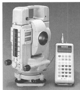
Die Totalstation Et-1 ist das Flaggschiff einer kompletten Gerätefamilie für die computerunterstützte und millimetergenaue Vermessung. Reichweiten von bis zu 2600 m, elektronische Winkelmessung, berührungslose Bedienung, automatische Kompensation der Erdkrümmung und externe Datenspeicher sind nur einige der vielen Rosinen.
