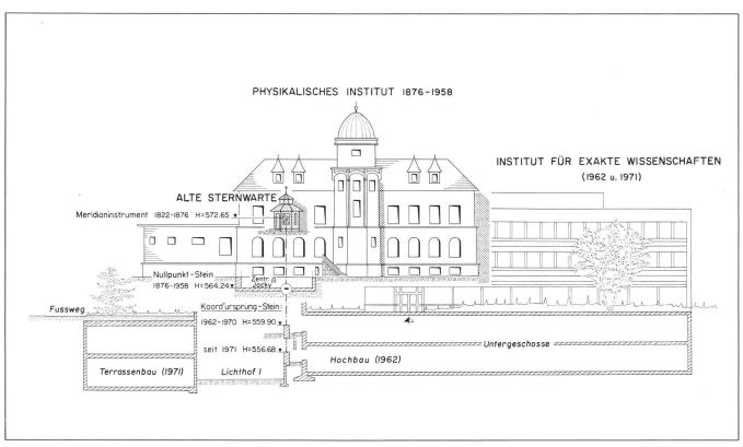
Abb. 2: Kombinierte Ansicht (z.T. Profil) der «Nullpunkt»- Gebäude
