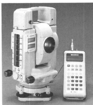
Die Totalstation Et-1 ist das Flaggschiff einer kompletten Gerätefamilie für die computerunterstützte und millimetergenaue Vermessung. Reichweiten von bis zu 2600 m, elektronische Winkelmessung, berührungslose Bedienung, automatische Kompensation der Erdkrümmung und externe Datenspeicher sind nur einige der vielen Rosinen.
