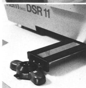
Bequeme Freihandführung für X-, Y- und Z-Bewegungen. Wahlweise werden auch X-, Y-Handräder, Z-Fußscheibe oder X-, Y-Trackball geliefert.
