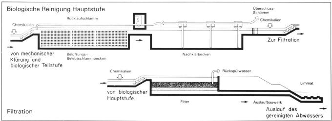
Abb. 3: Ausbau der Kläranlage Werdhölzli der Stadt Zürich. Oberes Bild: Mechanische Klärung. Unteres Bild: Biologische Reinigung und anschliessende Flockungsfiltration.
