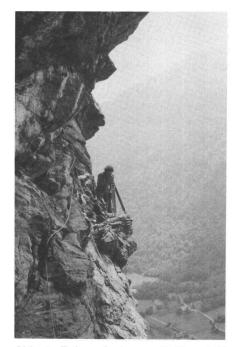
Abb. 4: Polaraufnahme mit Theodolit in steiler Wand; Sicherung mittels Seilgeländer.
