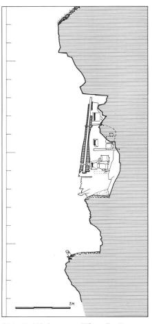
Abb. 5: Hérémence VS, «Grotte aux Fées», Beispiel eines Vertikalschnittes durch den oberen Bau von Abb. 2; mit Holz armierte, gegen den Berg geneigte Mauer; 4 sehr niedrige Abschnitte (Geschosse?), darin Lichtscharten und Wandfächer; unten Zugangsband zum unteren Bau mit Auflager eines ehemaligen Steigbaumes zum Eingang in den oberen Bau.
