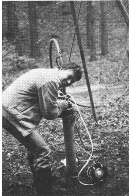
Abb. 1: Student bei der Messung der Brunnenabsenkung mit dem Lichtlot für einen Kleinpumpversuch im Rahmen des Vertiefungsblockes «Siedlungswasserwirtschaft und Umwelttechnik».
