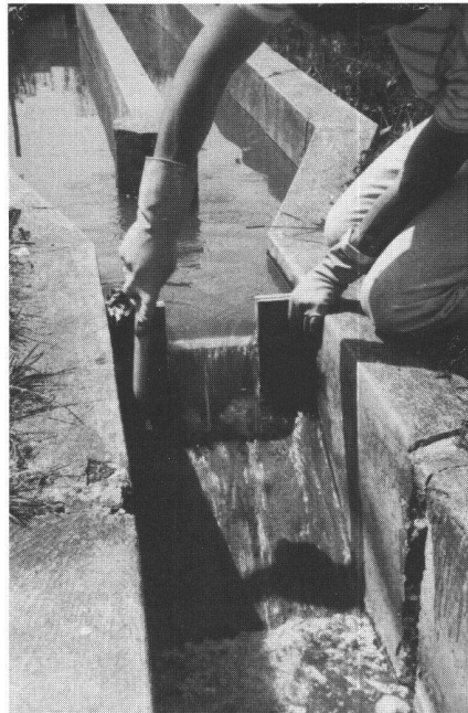
Abb. 3: Diplomand bei der Montage eines Messwehres zwecks Ermittlung des Abwasseranfalles in eine Kleinkläranlage.
