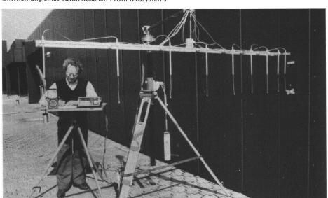
Ingenieurvermessung Temperaturgradienten-Messonde für die Untersuchung der Seitenrefraktion
