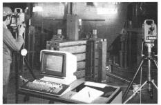
Ingenieurvermessung Entwicklung eines Robotertheodolits
