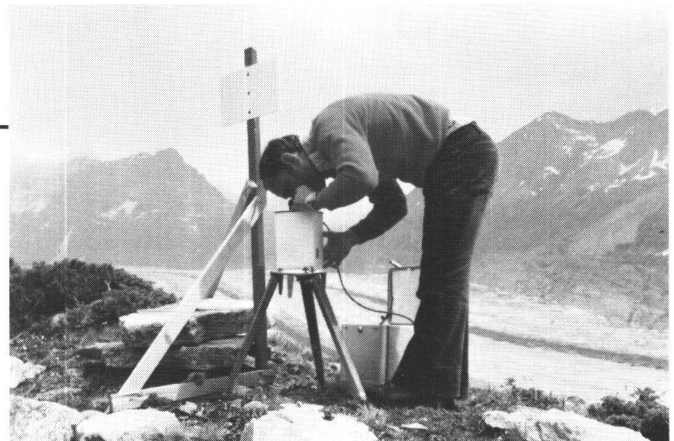
Gravimeter im Einsatz im Aletschgebiet
