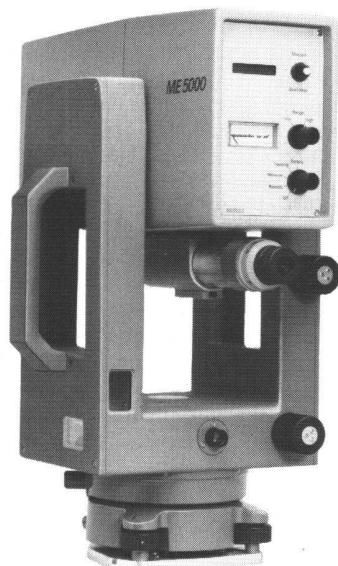
Das Helium-Laserlicht als Strahlungsquelle und ein einziger Kristall zur Modulation und Demodulation des Lichtes steigern die Genauigkeit auf  $\pm(0,2 \text{ mm} + 0,2 \text{ mm/km})$ ! Das 11 kg leichte Gerät ist damit bereits bei Distanzen über 200 m dem Sekundentheodolit zur Punktbestimmung überlegen.
