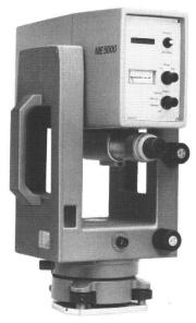
Das Helium-Laserlicht als Strahlungsquelle und ein einziger Kristall zur Modulation und Demodulation des Lichtes steigern die Genauigkeit auf  $\pm$  (0,2 mm + 0,2 mm/km)! Das 11 kg leichte Gerät ist damit bereits bei Distanzen über 200 m dem Sekundentheodolit zur Punktbestimmung überlegen.
