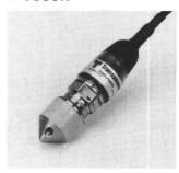
Mit ihrem konisch zugespitzten Einlass und nur 1 Zoll Aussendurchmesser lässt sich die Sonde BHL-4400-BA von Transamerica Instruments problemlos durch ein Peilrohr zur elektronischen Überwachung des Grundwasserpegels absenken. Die Sonde ist wasserdicht mit einem 6 mm starken Kabel verbunden, das auch im Dauerversuch keine messbare Längung zeigt. Im Kabel eingebaut ist ein Lüftungsschlauch, um dem Sensor den Atmosphärendruck als Bezugsdruck zu liefern.
