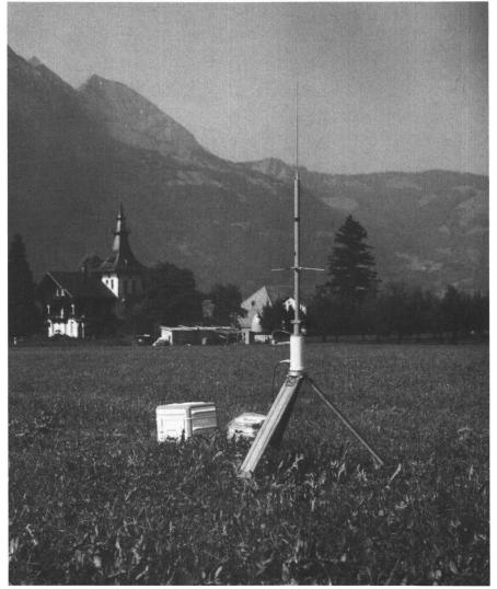
Abb. 3: Doppler-Empfänger MX-1502 des Instituts für Geodäsie und Photogrammetrie der ETH Zürich.
