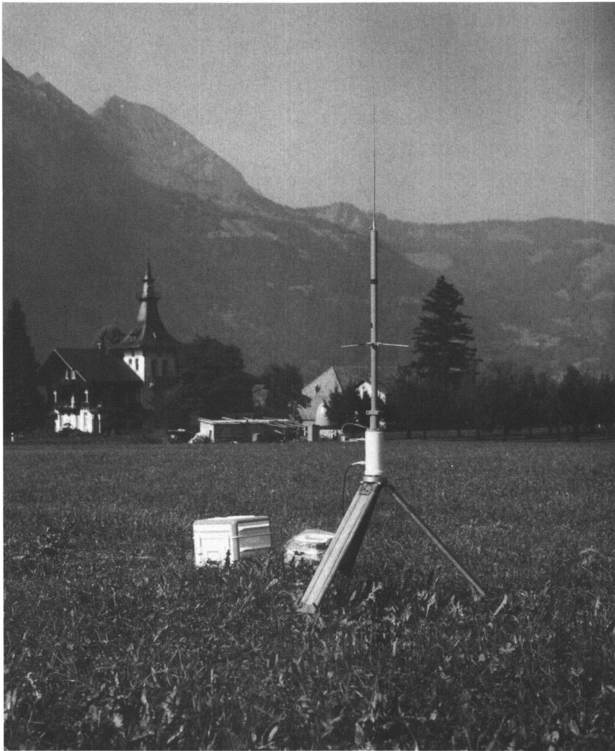
Abb. 3: Doppler-Empfänger MX-1502 des Instituts für Geodäsie und Photogrammetrie der ETH Zürich.
