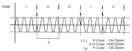
Abb. 4: Phasenmodulation der Trägerfrequenz
