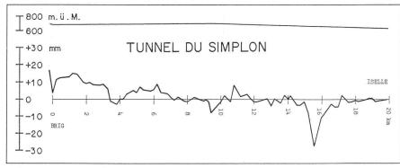
Fig. 5: D'après [5]. Mouvements verticaux entre 1917 et 1977.
