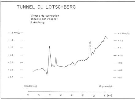
Fig. 3: D'après [10]. Mouvements verticaux entre 1909/15 et 1982/83.
