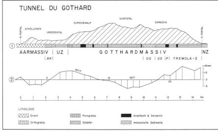
Fig. 4: D'après [7]. Mouvements verticaux entre 1906 et 1977.
