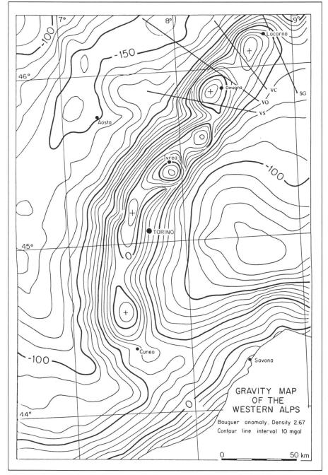
Abb. 3: Karte der Bouguer-Schwereanomalien für die Westalpen (nach Guillaume und Guillaume, 1980). Reduktionsdichte 2670 kg/m³, Terraineffekte berücksichtigt bis zu einer Distanz von 166.7 km. Die positive Schwereanomalie rührt von dem sogenannten «Ivrea-Körper» her. Lage der Schwereprofile im Nordteil der «Zone von Ivrea-Verbano» (siehe Abb. 4): SG = Schweizerische Geotraverse, VC = Val Cannobina, VO = Valle d'Ossola, VS = Val Sesia.
