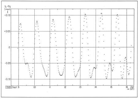
Abb. 2: Prognose für den zeitlich variablen Anteil  $\S g$  der Schwerebeschleunigung g (= Radialkomponente  $b_r$  des Erdgezeitenbeschleunigungsvektors  $\vec{b}$ ) in Zürich vorausberechnet für die Woche vom 9. bis 16. September 1986 (nach Drewes, 1986). Die theoretischen Werte für  $\S g$  (mgal) sind im Abstand von jeweils einer halben Stunde angegeben.
