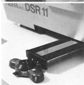
Bequeme Freihandführung für X-, Y- und Z-Bewegungen. Wahlweise werden auch X-, Y-Handräder, Z-Fussscheibe oder X-, Y-Trackball geliefert.
