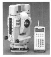
Die Totalstation Et-1 ist das Flaggschiff einer kompletten Gerätefamilie für die computerunterstützte und millimetergenaue Vermessung. Reichweiten von bis zu 2600 m, elektronische Winkelmessung, berührungsfreie Bedienung, automatische Kompensation der Erdkrümmung und externe Datenspeicher sind nur einige
