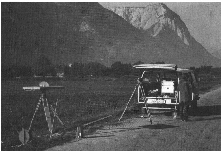
Abb. 4: MACROMETER V-1000 auf der Station 7 (Turtmann). Der Empfänger (grosse Box) ist im Wagen untergebracht. Die für die Macrometer V-1000 typische Antennengrundplatte ist deutlich zu erkennen. Die Antennenhöhen wurden nivelliert.
