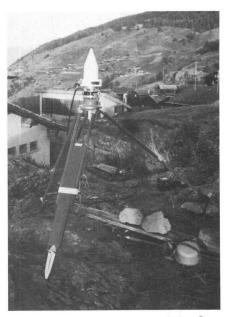
Abb. 5b: TI-4100-Antenne auf der Station 3 (Jeizinen).
