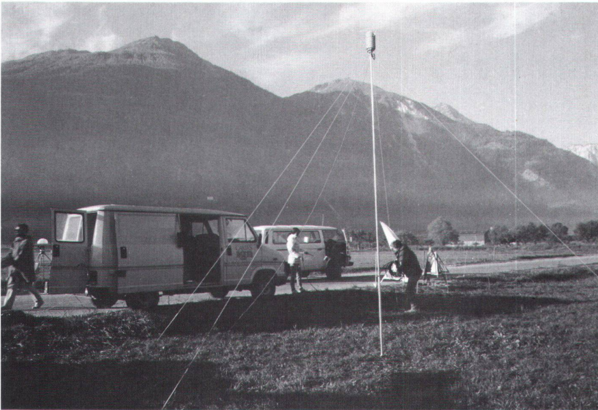
Abb. 9: Der 5 m hohe Aluminium-Teleskopmast trägt eine Druck-, Temperatur- und Feuchtigkeitssonde, die mit einer automatischen Registriereinheit verbunden ist.
