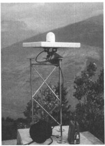
Abb. 3b: SERCEL TR5S-Antenne mit Stahlpfeiler der L+T auf der Station 5 (Oberems). Die Empfangsantenne befindet sich in der Kuppel über der Antennengrundplatte. Der Vorverstärker ist in der Box unter der Antennengrundplatte eingebaut.
