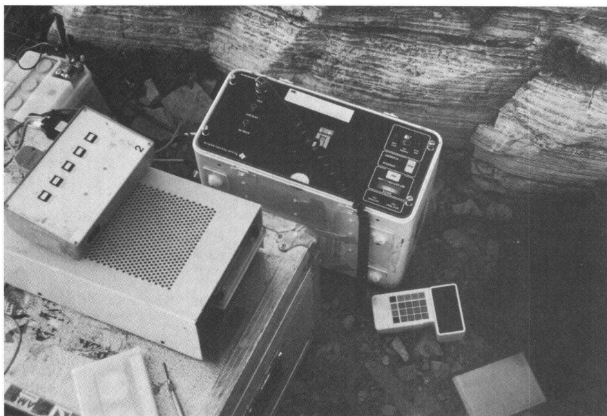
Abb. 5a: TI-4100-Empfänger mit dem Bedienungspanel. Im Vordergrund die Kassettenregistriereinheit.
