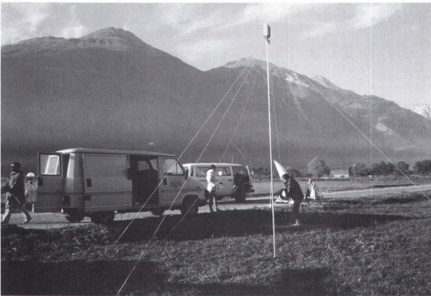
Abb. 9: Der 5 m hohe Aluminium-Teleskopmast trägt eine Druck-, Temperatur- und Feuchtigkeitssonde, die mit einer automatischen Registriereinheit verbunden ist.
