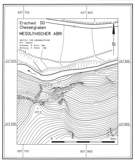
Beispiel einer archäologisch-topographischen Kartierung mittels Bussolentachymetrie; graphische Ausarbeitung im Hinblick auf eine Verkleinerung in den Massstab 1: 1000, ev. 1: 2000 (im Original Aequidistanz 2 m, mit Zwischenkurven bei Bedarf).
