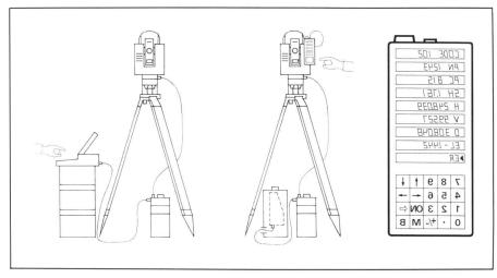
Abb. 1 Links: Datenterminal. Die Anzeige umfasst neun Werte. Diese neun Werte entsprechen der in Abbildung 2 hervor gehobenen aktuellen Werte.
