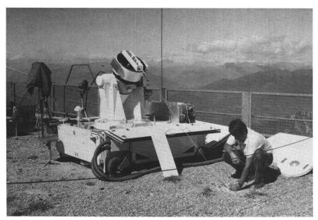
Abb. 6: Einmessen des genauen Teleskop-Standortes bezüglich der 5 Versicherungsbolzen, die in massiven Betonklötzen eingelassen sind. Die Messungen erfolgen mittels eines Stahl-Messbandes und eines Hilfslasers, der an der Front des Teleskops montiert ist.
