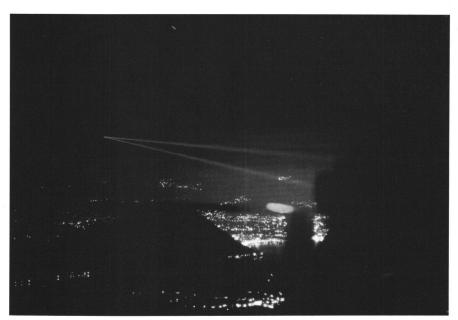
Abb. 8: MTLRS 2 beim Messen der Distanz Monte Generoso-Jungfraujoch. Die zwei Teilstrahlen entstehen durch Aufspaltung des Hauptstrahls. Das «blinde» Zentrum der Optik, wo ein Hilfsfernrohr zur Detektion von Flugzeugen oder der Sonne montiert ist, wird dadurch ohne Energieverlust ausgeblendet. Im unteren Bildteil sind die Lichter von Lugano sichtbar. Die Entfernung zum Jungfraujoch beträgt ca. 106 km.
