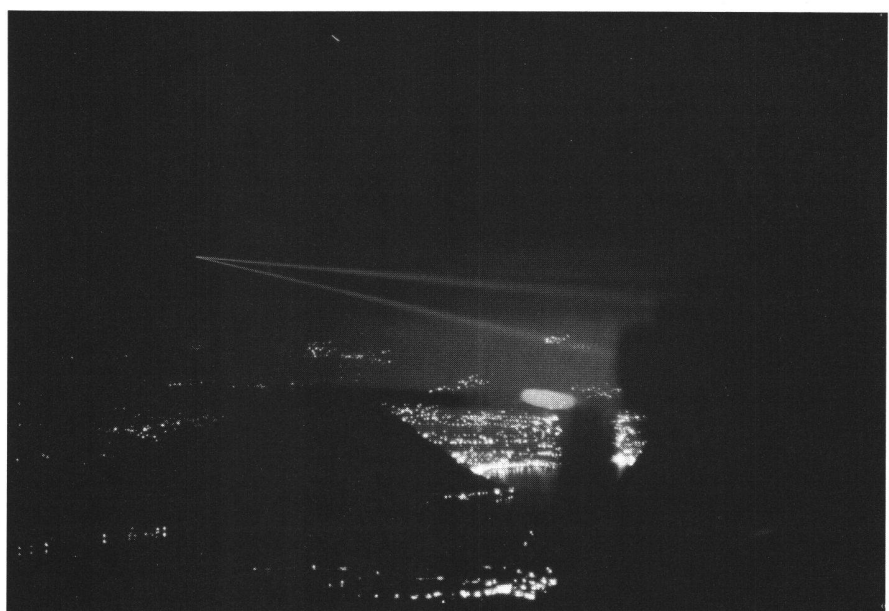
Abb. 8: MTLRS 2 beim Messen der Distanz Monte Generoso–Jungfraujoch. Die zwei Teilstrahlen entstehen durch Aufspaltung des Hauptstrahls. Das «blinde» Zentrum der Optik, wo ein Hilfsfernrohr zur Detektion von Flugzeugen oder der Sonne montiert ist, wird dadurch ohne Energieverlust ausgeblendet. Im unteren Bildteil sind die Lichter von Lugano sichtbar. Die Entfernung zum Jungfraujoch beträgt ca. 106 km.
