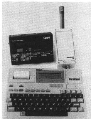
Messumformer HYGROTEST 55 – eine neue Generation von Messwertaufnehmern zur stationären Erfassung der relativen Luftfeuchte und gleichzeitiger Temperaturnmessung. In Verbindung mit dem Speicher-Logger GRANT sind die Messdaten von 0,1 sek. bis 100 min. erfassbar und werden über einen Computer ausgewertet. Der
