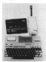
Messumformer HYGROTEST 55 – eine neue Generation von Messwertaufnehmern zur stationären Erfassung der relativen Luftfeuchte und gleichzeitiger Temperaturmessung. In Verbindung mit dem SpeicherLogger GRANT sind die Messdaten von 0,1 sek. bis 100 min. erfassbar und werden über einen Computer ausgewertet. Der
