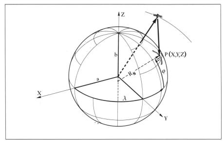
Abb. 1: Räumliche geozentrische kartesische Koordinaten (X, Y, Z) und ellipsoidische (geodätische) Koordinaten ( $\Psi$ ,  $\lambda$ , h). Der Ursprung des kartesischen Systems (X, Y, Z) liegt im Erdschwerpunkt (Geozentrum). Die Z-Achse ist die mittlere Rotationsachse der Erde. Die (X, Z)-Ebene enthält das mittlere Observatorium von Greenwich. (X, Y)-Ebene = Aequatorebene. a, b = Ellipsoid-Halbachsen. R<sub>N</sub> = Querkrümmungsradius des Rotationsellipsoids.
