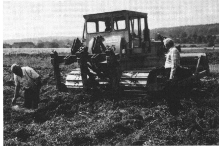
Abb. 3 Cat. D 6 C beim Lockern der Versuchsfläche.
