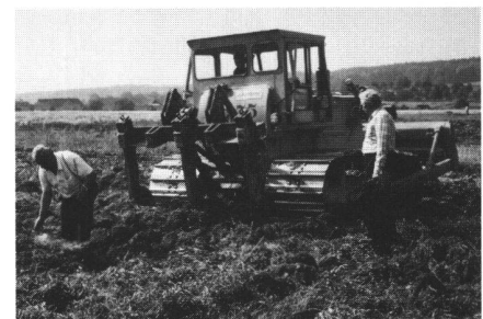
Abb. 3 Cat. D 6 C beim Lockern der Versuchsfelder.
