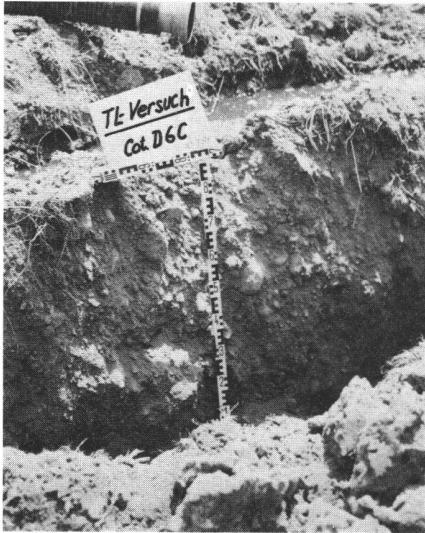
Abb.7 Infiltrationsversuch im gelockerten Boden.
