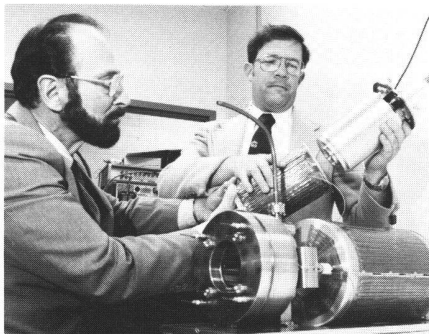
Irwin Baker (links) und John Lange, Assistant Programme Manager (rechts), beim Inspizieren eines Prototyps der Wasserstoffmaser-Atomuhr, die von den Hughes Research Laboratories entwickelt und von ihrer Space and Communications Group neu für die Raumfahrt konzipiert wurde.
