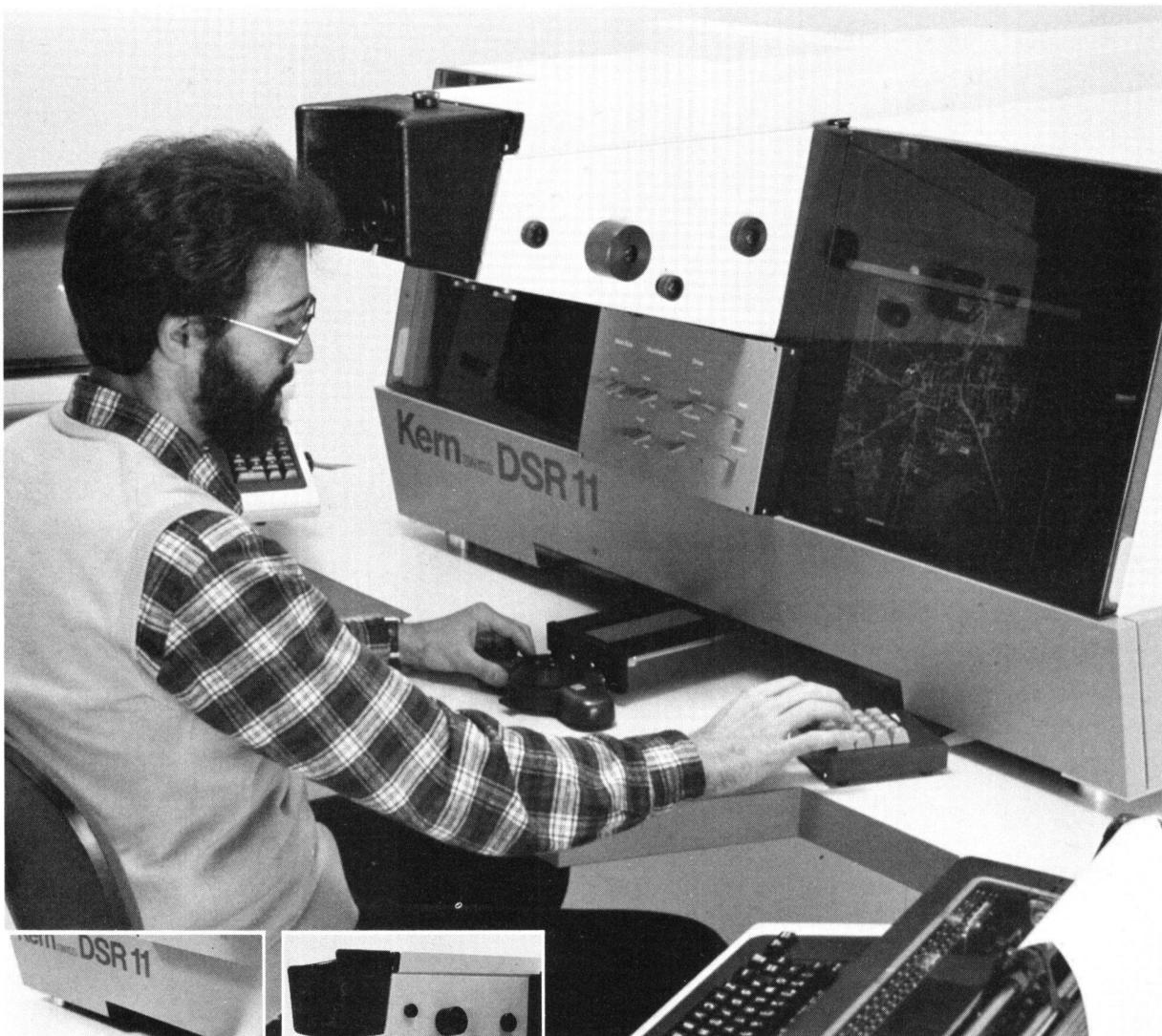
Bequeme Freihandführung für X-, Y- und Z-Bewegungen. Wahlweise werden auch X-, Y-Handräder, Z-Fußscheibe oder X-, Y-Trackball geliefert.
