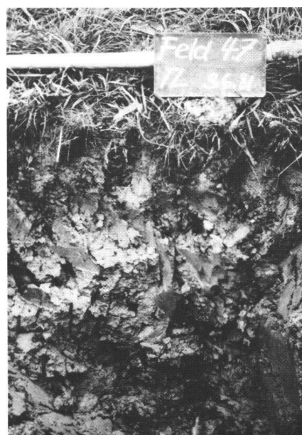
Abb. 2 Das schnell drainierende Grobporensystem wird sichtbar (dunkle Stellen), wenn das Bodenprofil direkt unter der Infiltrationsfläche geöffnet wird.
