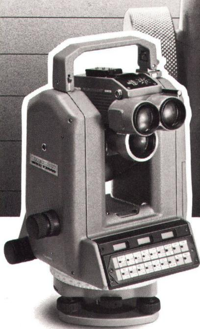
Der DISTOMAT Wild DI5 erweitert das führende Wild-Baukastensystem um ein handliches und besonders leistungsfähiges Modell: mit hoher Reichweite, beachtenswerter Genauigkeit von 3 mm + 2 mm/km und einem überdurchschnittlichen Bedienungskomfort.
