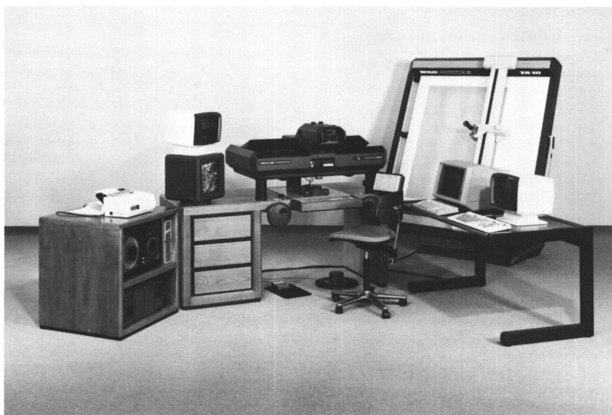
Wild BC2 Der neue Aviolyt Wild BC2 in seiner umfassendsten Ausbaustufe. Rechts der graphische Farbbildschirm zur Dateneditierung, ein zweiter alphanumerischer Bildschirm zur Ablaufkontrolle simultan verarbeiteter Applikationsprogramme sowie der Präzisions-Zeichentisch Aviotab Wild TA10.
