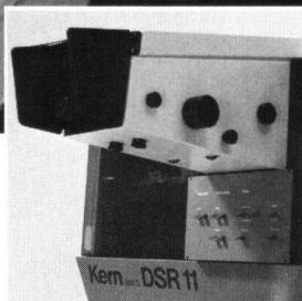
Bequeme Freihandführung für X-, Y- und Z-Bewegungen. Wahlweise werden auch X-, Y-Handräder, Z-Fußscheibe oder X-, Y-Trackball geliefert.
