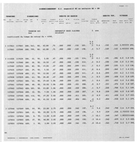
Fig. 4 Exemple de calcul hydraulique
