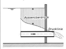
Abb.1 Ausfluss aus einem Becken durch ein Rohr. Schematische Darstellung der Drucklinie und des Aussenüberdruckes
