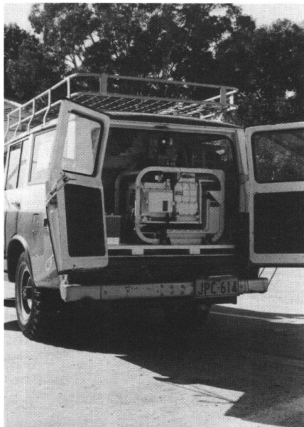
Abb.1 LITTON Auto-Surveyor System II in Toyota Landcruiser. Ein elektronischer Tachymeter Hewlett-Packard HP 3820A ist auf dem Rahmen des Trägheitsvermessungssystems befestigt und dient der Einmessung der Vermessungspunkte. Die rückseitigen Türen des Fahrzeuges werden zu diesem Zweck offen gehalten.
