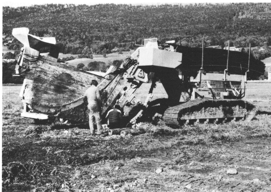
Fig. 7 Drainage 1983, draineuse, réparation de la chaîne
