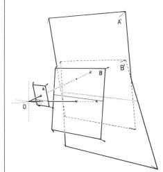
Abb. 4 Schematische Darstellung der Umbildung der (Teil-)Aufnahmen A und B zur kombinierten Abbildung (Photomontage) A'B'. Bildebenen in Positivsstellung ( $c \rightarrow -c$ )
