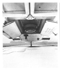
Abb. 2 Aufnahme (A) vom Flugzeug Pilatus Turbo Porter PC-6 mit eingebauter Kammerausrüstung Wild Aviophot RC10A
